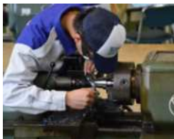
(機械科実習 旋盤加工)
